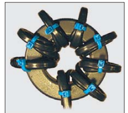
Bild 8: Bewicklung mit 8 \times 3 Windungen, wobei jeweils drei Windungen übereinander liegen und durch Kabelbinder fixiert werden
