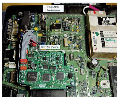
Eine von Jan, DO1FJN, mit einer zusätzlichen Platine zu einem D-STAR-Funkgerät ergänzte Platine eines alten C-Netz-Funktelefons Foto: DO1FJN
