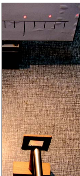
Bild 1: Versuchsaufbau mit Laser- pointer, Beugungsgitter und Schirm nebst Skala Fotos: DL6XZ
