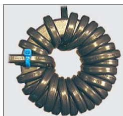
Bild 10: Zweilagige Bewicklung mit 28 Windungen; die untere Ebene besitzt 17 Windungen, die obere 11.
