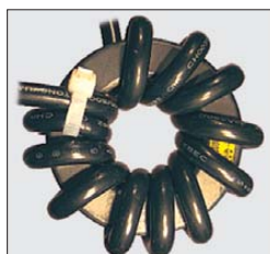
Bild 12: Einlagige Bewicklung mit 12 Windungen driadriger Netzleitung Fotos: DF6GF (6), Red. FA (1)
