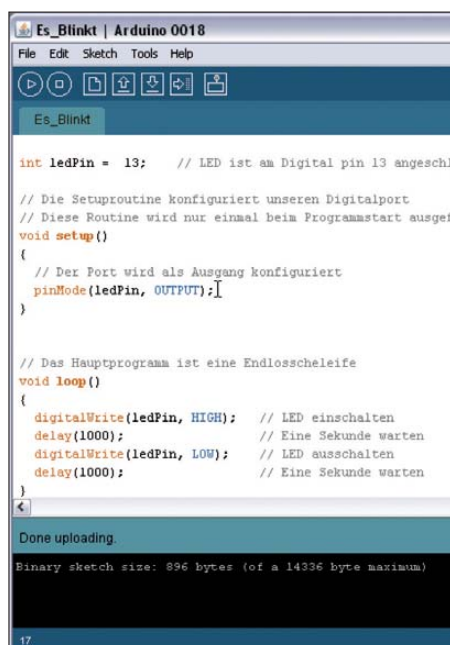
Bild 4: Arduino besitzt eine eigene Entwicklungsumgebung. Die Software gestattet die Programmierung in der Sprache C und das Einladen des Programms in den Mikrocontroller per Mausklick.
