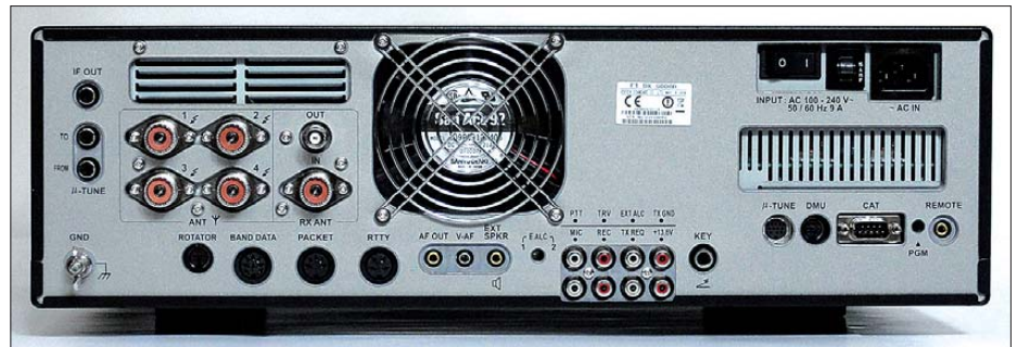
Bild 3: Rückansicht des FTdx5000; vier Antennenbuchsen plus Durchschleifbuchsen für den Empfangszweig sowie der Sicherungsautomat neben dem Netzschalter sind nützliche Details. Drei Buchsen werden zum Anschluss des SM-5000 benötigt.
