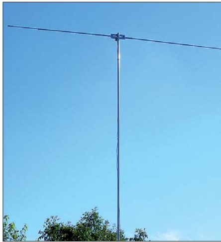
Bild 16: 2 × 2,50-m-Dipol aus 20-mm- und 16-mm-Aluminiumrohren für das 10-m-Band Fotos: DK7ZB
