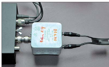
Bild 9: Anschluss einer Zweidraht-Speiseleitung über Balun direkt am Gerät
