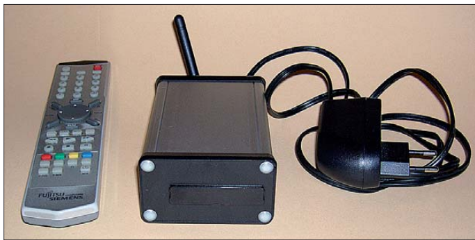
Bild 1: Ansicht des ersten Aufbaus des IR-Empfängers im Aluminiumgehäuse mit Fernbedienung und Steckernetzteil
