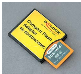
Eye-Fi Pro X2 in einem CF-SDHC-Adapter, Bezugsquelle: Pearl
