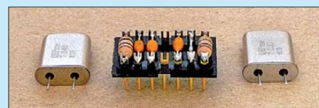
Bild 5: Auf den Bauteilträger kommen alle band- und frequenzabhängigen Bauteile. Er ermöglicht zusammen mit dem Quarz einen schnellen Bandwechsel. Fotos: DK3RED
