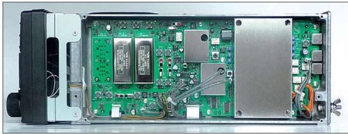
Bild 5: Linke Seitenansicht des FTdx5000; links im Bild die Roofing-Filter des Hauptempfängers, ganz links der freie Platz für das nachrüstbare 300-Hz-Filter
