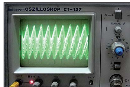
Bild 5: Oszilloskopdarstellung bei einer Auslenkung von 10 \mu s/Div; nun sind auch die höherfrequenten Flimmerfrequenzen erkennbar (hier 100 kHz und Oberwellen).
