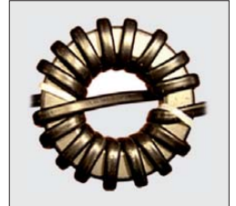
Bild 7: Einlagige Bewicklung mit 17 Windungen und gekreuzter Wicklung nach W1JR
